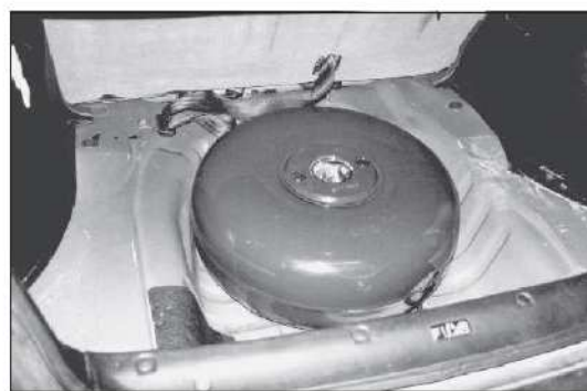
Rys.11 Widok zamontowanego zbiornika toroidalnego
