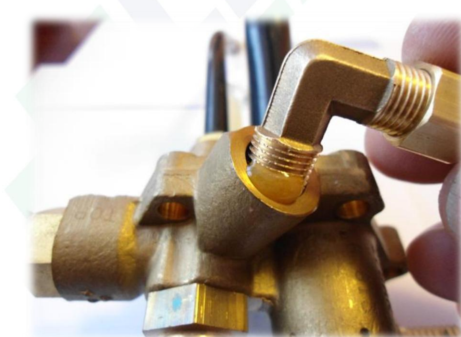
Rys. nr 7. Wkręcić kolano z gwintem NPT do wyjścia gazu z naniesionym j.w. klejem uszczelniającym do połączeń gwintowanych np. typu LOCTITE 577.
