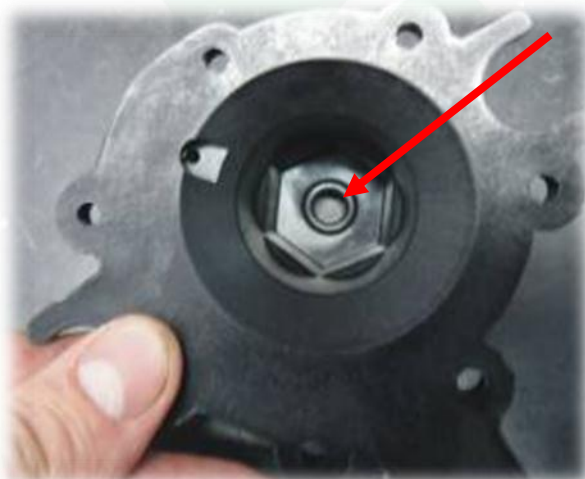
Rys. nr 3. Widok o-ring 8x3 w gnieździe.
