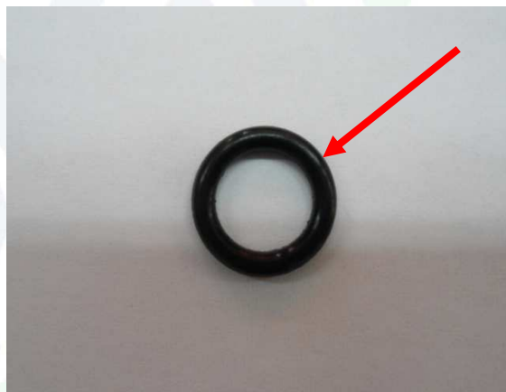
Rys. nr 2. Nowy grubszy O-ring 7,66x2,62.
