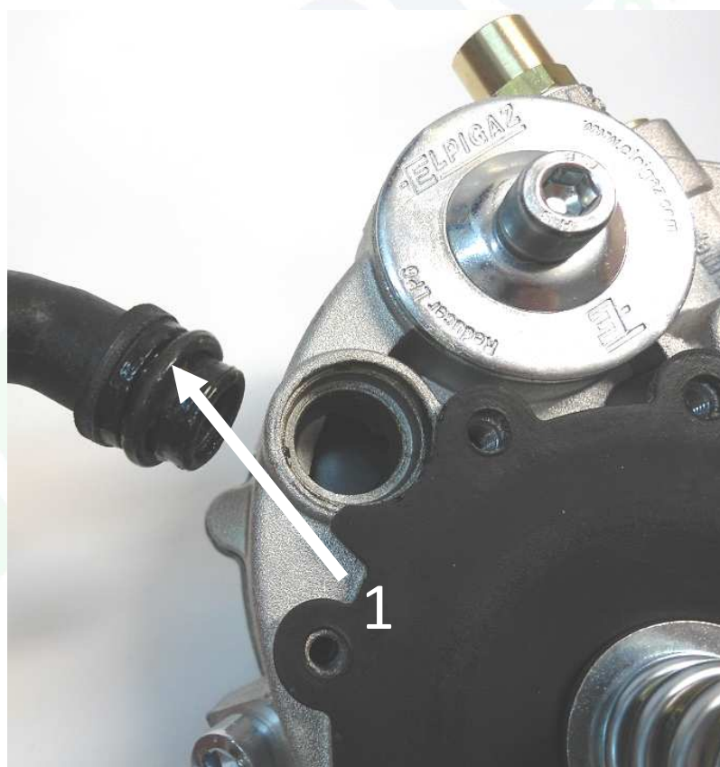
Rys.3 O-ring uszczelniający kolanko nr2
