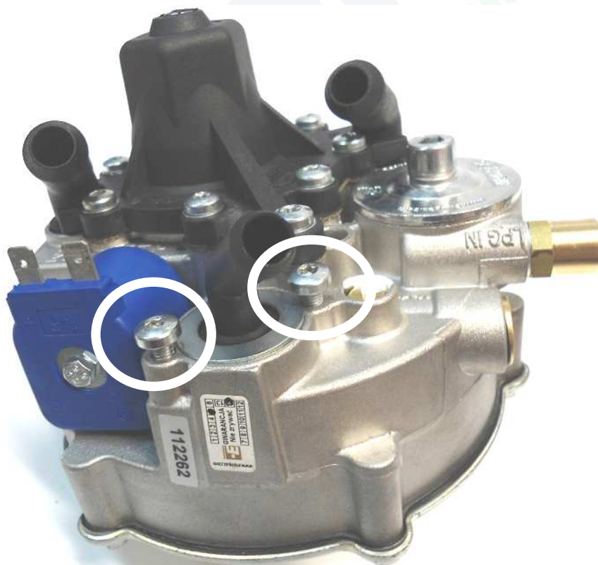
Rys.1 Śruby mocujące króciec wyjścia gazu.
