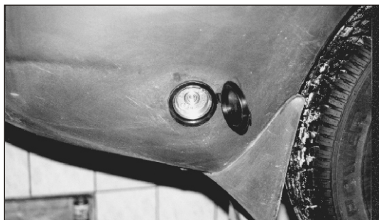
Rys.70. Zamontowany wlew gazu.
