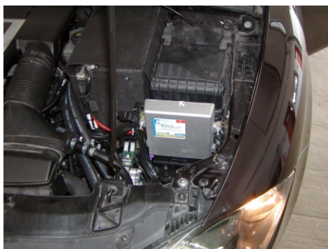
Rys.22.B.Przykładowe zamocowanie sterownika ECU GAZ
