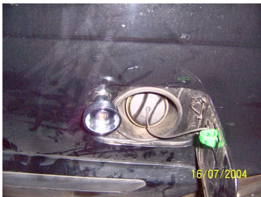
Rys.71. Miejsce montażu wlewu gazu Small.
