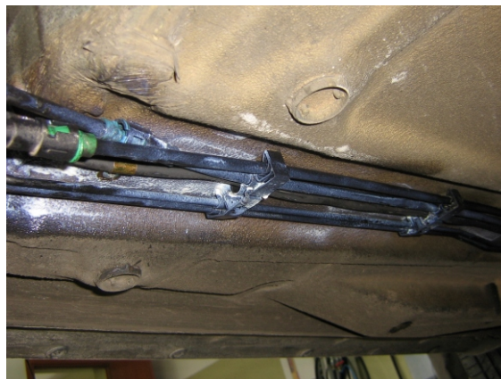
Rys.64. Wyprowadzenie przewodów ze zbiornika do reduktora.
