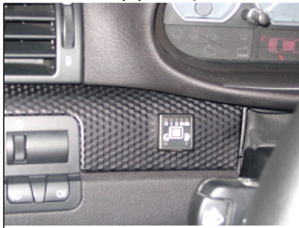
Rys.31.Zamontowany przełącznik na desce rozdzielczej.
