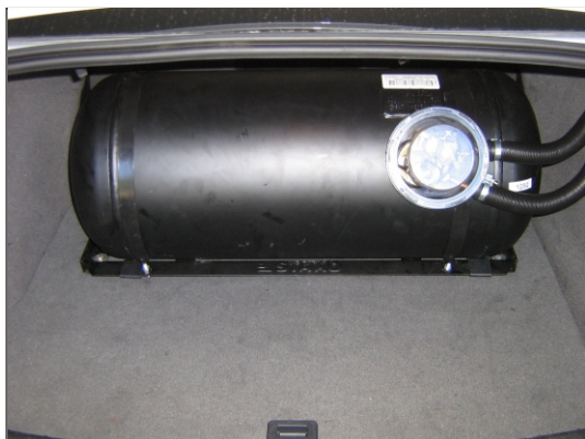
Rys.61. Przykładowe ustawienie zbiornika cylindrycznego.
