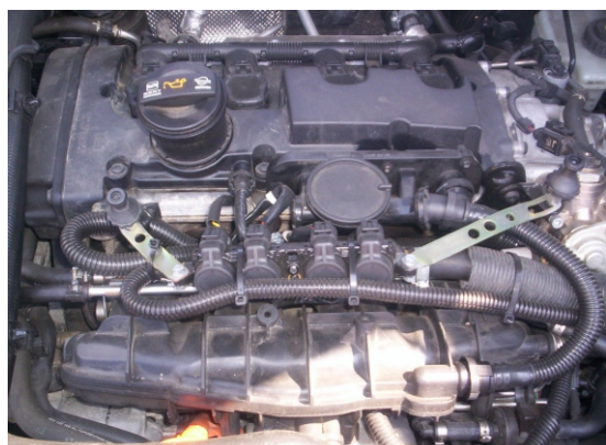
Rys.19. Przykład zamocowania bloku wtryskiwaczy I-PLUS
