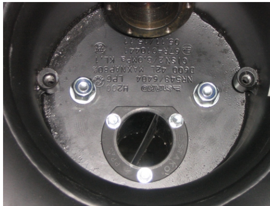
Rys.69. Widok zamontowanego zbiornika toroidalnego wewnętrznego.
