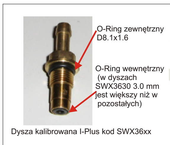
Rys. 28. Dysza kalibrowana.
