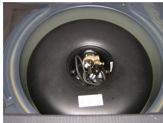
Rys.68. Widok zamontowanego i uzbrojonego zbiornika toroidalnego wewnętrznego.
