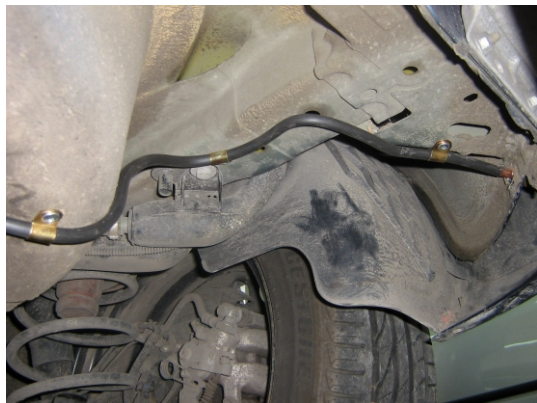
Rys.74. Poprowadzenie przewodu zasilającego D8.
