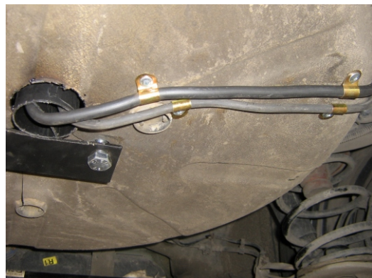
Rys.63. Wyprowadzenie przewodów ze zbiornika toroidalnego.
